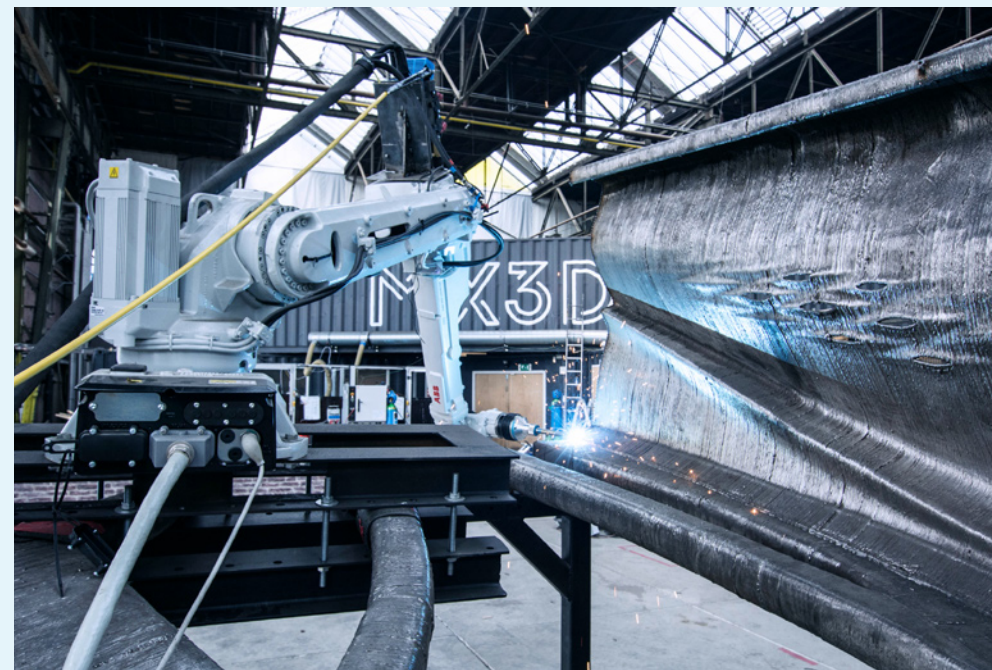
Nīderlandiešu uzņēmuma MX3D robots veic tērauda tilta 3D druku. Foto: MX3D.
